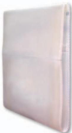
I laminati sono costruiti in poliestere speciale, idoneo ad essere inciso al laser. L'incisione riproduce l'immagine desiderata e attraverso i microfori lo smalto secco di deposita sul supporto. Le dimensioni del laminato sono 2150 mm di sviluppo per 680 mm di larghezza. I laminati, di struttura flessibile, rendono più semplici le procedure di montaggio ed occupano minimi spazi di stoccaggio.
