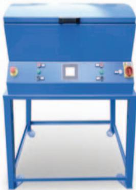
Mulino lento per la macinazione con giare cilindriche. Il mulino è composto da 2 o 4 rulli in acciaio ricoperti in PVC su cui vengono fatte ruotare le giare in porcellana alluminosa, con una carica di sfere, acqua e materiale da macinare. La macinazione è ottenuta mediante la rotazione della giara.
