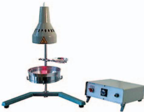
Lampada portatile per la rapida essiccazione di qualsiasi prodotto tramite il piattello inox, e per la determinazione del residuo per mezzo dei setacci.
