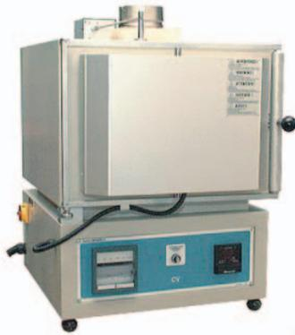
I forni a muffola per laboratorio sono costruiti in robusta lamiera di acciaio verniciata a polvere epossidica e con isolamento a doppio strato in fibra ceramica. Facile ed economica conduzione per prove di laboratorio per temperatura max 1050 °C o 1280 °C. Il riscaldamento con una serie di resistenze posizionate sul fondo e lateralmente permette una buona uniformità di cottura e un agevole manutenzione nell'eventualità di una loro sostituzione. Dimensioni e temperature a richiesta.
