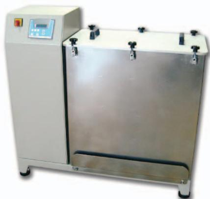
Strumento da laboratorio per stabilire l'assorbimento di acqua sottovuoto nelle piastrelle ceramiche con cicli completamente automatici. La prova sottovuoto è così determinata: posizionare le piastrelle in un'apposita griglia nella vasca; fare partire il ciclo con la pompa del vuoto. In questo modo è possibile determinare la porosità apparente, la densità relativa apparente e l'assorbimento d'acqua.
