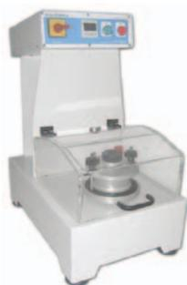
Strumento da laboratorio per la determinazione della resistenza all'abrasione su piastrelle smaltate (metodo P.E.I. ed MCC) Il campione viene bloccato (con un apposito supporto contenente una carica abrasiva composta da sfere calibrate in acciaio inox, acqua distillata e corindone grana F80) su un piatto ruotante e oscillante tangenzialmente.
