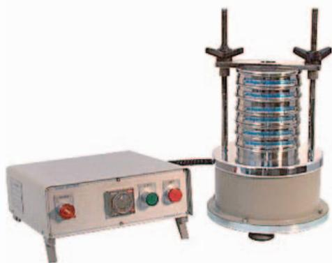
Idoneo ad ospitare n. 7 setacci Ø 200 mm. Altezza 50 mm., più fondo e coperchio. Protezione esterna in acciaio verniciato a polvere epossidica. Piatto portasetacci in alluminio. Aste di allineamento in acciaio. Quadro di controllo con temporizzatore 0÷30 min, pulsante di marcia, pulsante di arresto. Alimentazione elettrica V. 230 monofase 50 hz.
